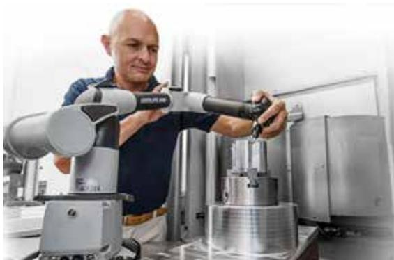
Nous disposons de moyens de contrôle très complets notamment une machine de mesure tridimensionnelle, un profilomètre et un bras de mesure 3D dernière génération.
